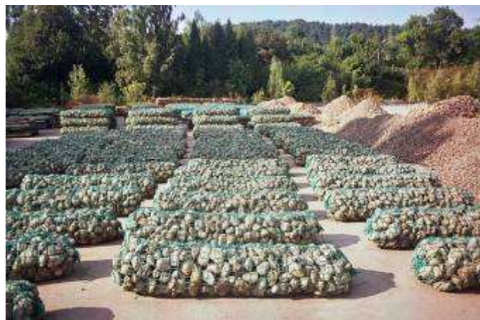
Walce kamienne o średnicy 40cm. i dł 2m. ważą około 150 kg. na mb. Wykonane w dziale prod.
