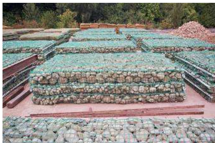
Komorowe materace kamienne 2x2x0,25m wykonujemy w naszym dziale produkcyjnym.
